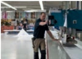
Mit unseren Hochfrequenz-Schweißmaschinen verbinden wir PVC-Bahnen zu noch größeren Formaten oder verstärken die Ränder für mehr Haltbarkeit.
