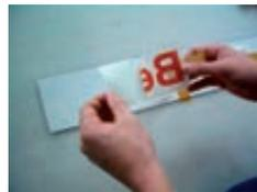
3. Lösen Sie das Klebeband an der linken Seite des Aufklebers und klappen Sie die Seite um, so dass Sie die Rückseite der Folie sehen. Ziehen Sie das undurchsichtige Trägerpapier in einem Winkel von 180° ab. Achten Sie darauf, dass die Motive auf der Montagefolie haften bleiben. Die Klebeschicht möglichst wenig berühren.
