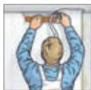
**6.** In den Ecken wird die Trennung mit dem Tapezier-spachtel und einem Cuttermesser oder mit einer Schere ausgeführt.
