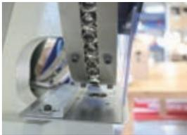
Nach der Randverstärkung der Banner- oder Netzvinyle werden Kunststoff- oder Metallösen angebracht. Mit modernen Automaten erzielen wir ein optisch und technisch einwandfreies Ergebnis.
