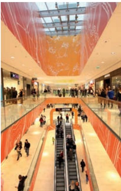
Auch die Lichtkuppel wurde im Design der Wände beklebt. Da diese der Sonneneinstrahlung direkt ausgesetzt ist, wurde ebenfalls eine Lackierung vorgenommen. Diese verhindert das schnelle Ausbleichen der Farben.
