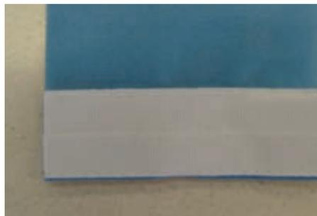
Zur Verstärkung besonders beanspruchter Kanten wird ein Besatzband angenäht.
