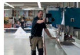
PVC-haltige Materialien werden mit unserer Hochfrequenz-Schweißmaschine weiterverarbeitet. Bahn an Bahn zusammenschweißen, randverstärken oder mit Hohlraum versehen sind unsere täglichen Arbeiten.
