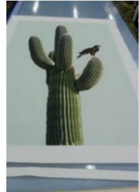
Nach dem Druck wird das Motiv mit der benötigten Zugabe aus der Rolle geschnitten und zur Verspannung in einem Keilrahmen zurecht gemacht.
