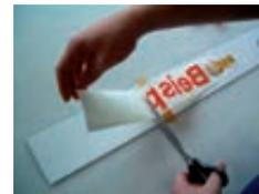
Schneiden Sie das Trägerpapier mit Hilfe einer Schere ab.
