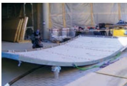
Dieser gebogene Spannrahmen-Kasten hat eine Größe von 6 x 3 m. Er wird mit LEDs beleuchtet.
