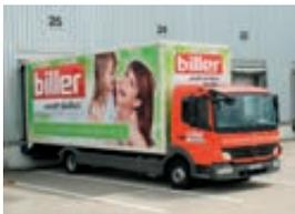
Der Hartkofferaufbau eines LKWs wurde mit einer Folie vollständig verklebt.
