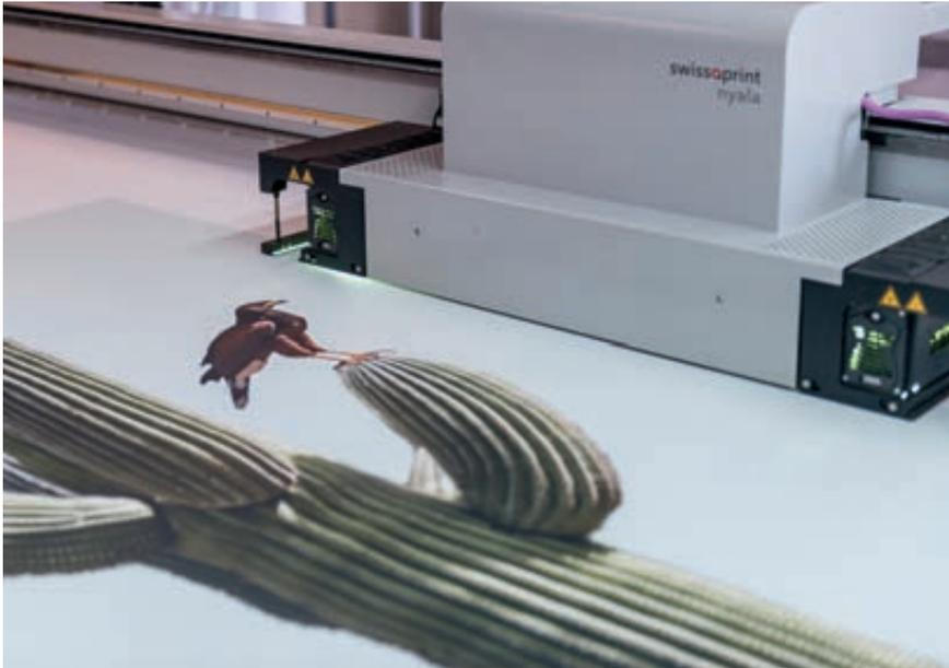
Unsere modernen und hochauflösenden Plattendrucker vom Schweizer Hersteller SwissQ Print bedrucken starre Plattenmaterialien genauso wie flexible Rollenmaterialien. Dazu kann die Maschine einfach umgebaut werden. Somit können auf der gleichen Maschine auch verschiedene Materialien eines Auftrages in der gleichen Auflösung gedruckt werden.
