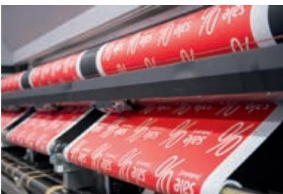
Unsere modernen Maschinen mit 5 m Druckbreite lassen sich auch im Einsatz mit 3 Rollen je 1,52 m Breite nutzen. Damit lassen sich Papiere und Folien effizient bedrucken.
