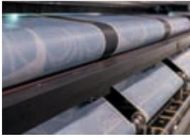
Unsere modernen Maschinen mit 5 m Druckbreite lassen sich auch im Einsatz mit 3 Rollen je 1,52 m Breite nutzen. Damit lassen sich Vliestapeten effizient bedrucken.
