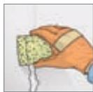
**5.** Aus-tretenden Kleber sofort mit feuchtem Schwamm oder Tuch entfernen.
