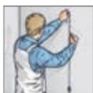
**1.** Der Untergrund muss trocken, sauber, fest, saugfähig und glatt sein. Die Breite der Bahn auf der Wand markieren und ausloten.
