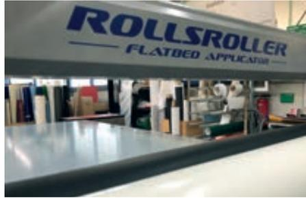
Mit dem Rollsroller lassen sich Aufzieharbeiten blasen- und knitterfrei erledigen. Gerade bei hohen Auflagen passiert dies in kürzester Zeit.
