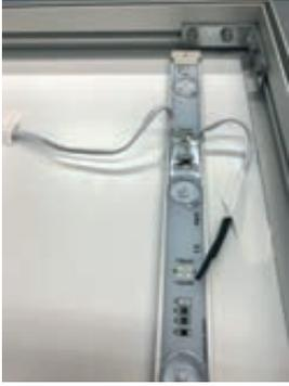
Bestückung von Leuchtkästen mit LED-Leisten zur späteren Montage.
